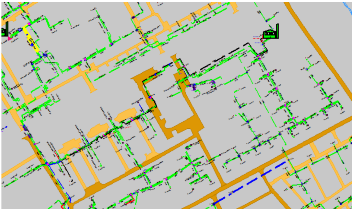
Рисунок 1.117 Результат гидравлического расчета - расчетный путь теплоносителя от котельной ул. Иванова, 36-б до ПТ-Кораб,9 Э2
