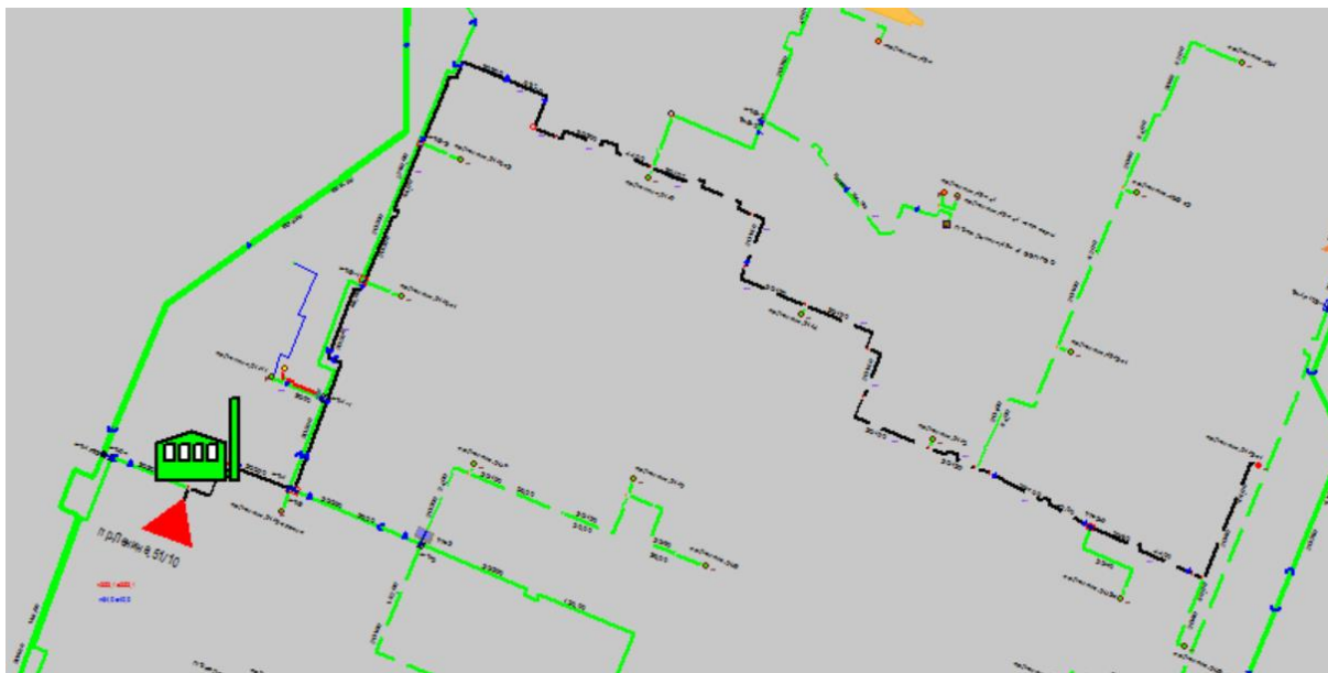
Рисунок 1.85 Результат гидравлического расчета - расчетный путь теплоносителя от котельной пр. Ленина, 51 корпус 10 до ПТ-пр.Ленина,51/2 э1
