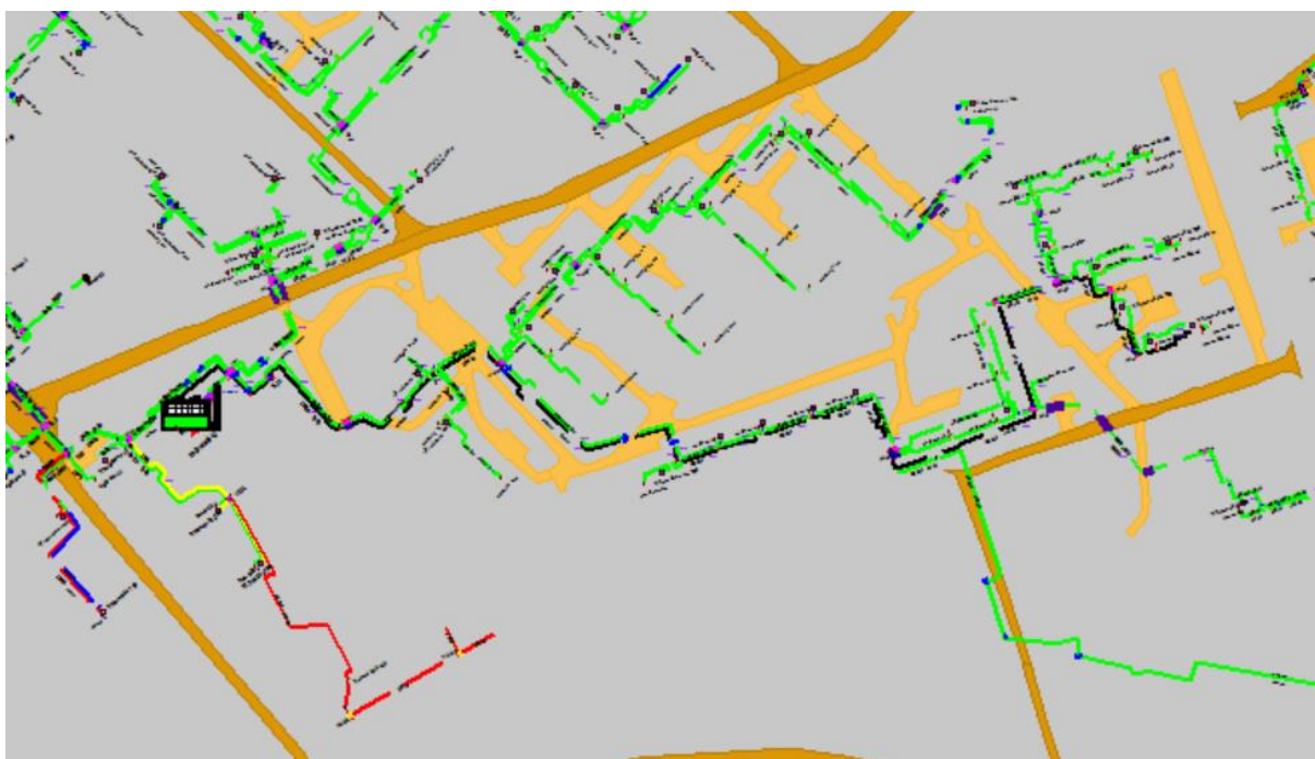
Рисунок 1.61 Результат гидравлического расчета - расчетный путь теплоносителя от котельной пр. Союзный, 43 до ПТ-Комин,256 э2
