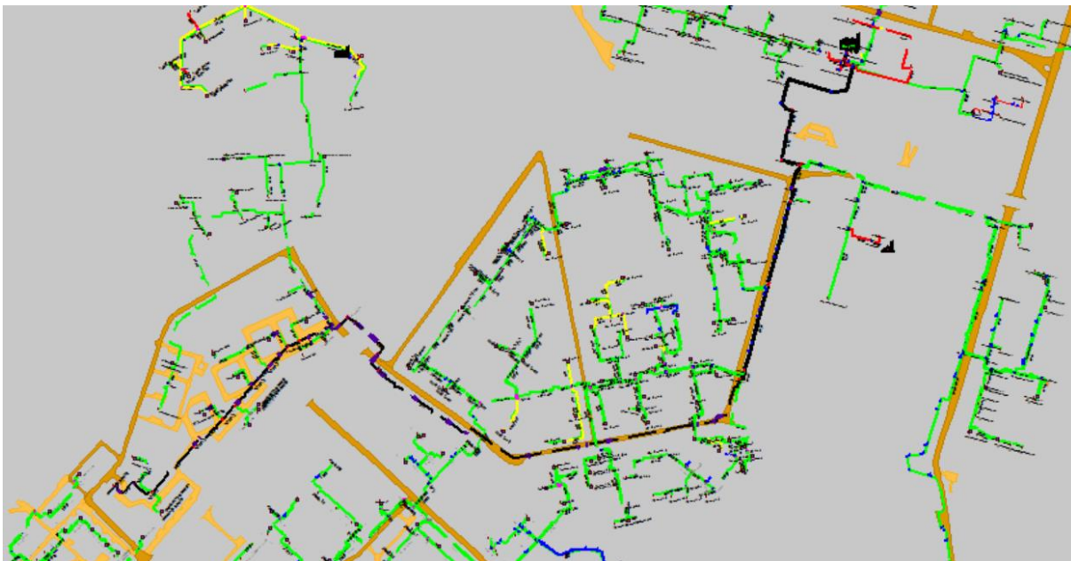
Рисунок 1.57 Результат гидравлического расчета - расчетный путь теплоносителя от котельной пр. Гагарина, 1786 до ПТ-Гагар.пр,101 к5 ИТП №2
