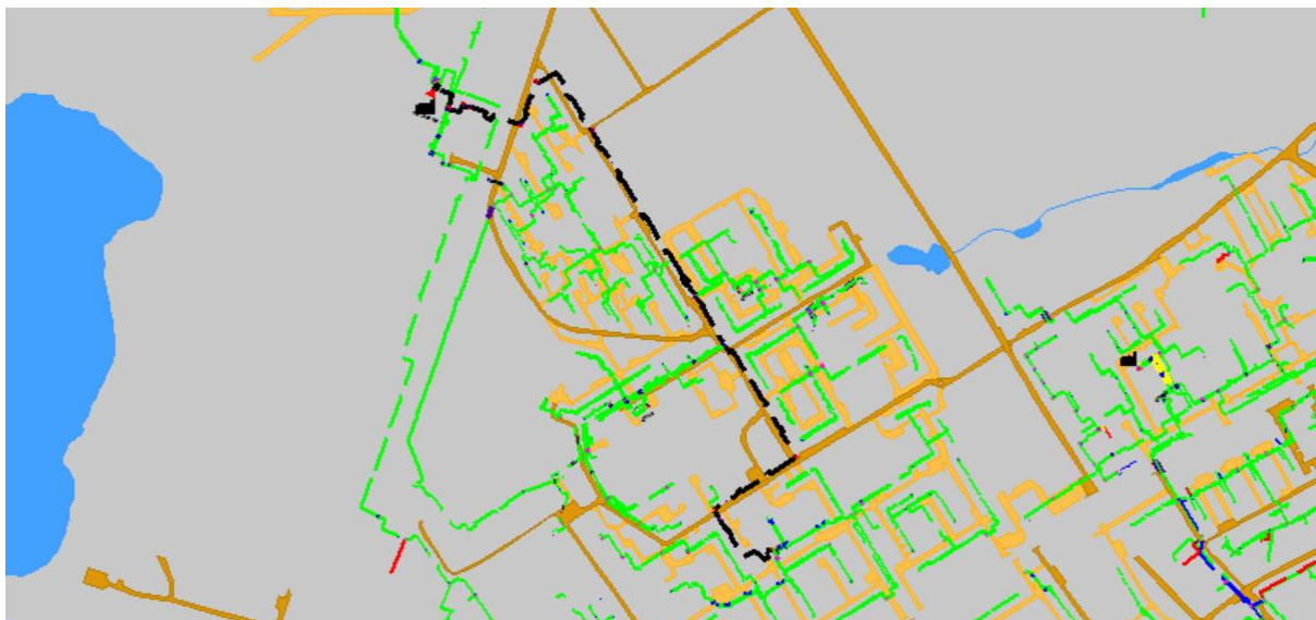
Рисунок 1.183 Результат гидравлического расчета - расчетный путь теплоносителя от котельной Зайцева, 31 до ЦТП-504
