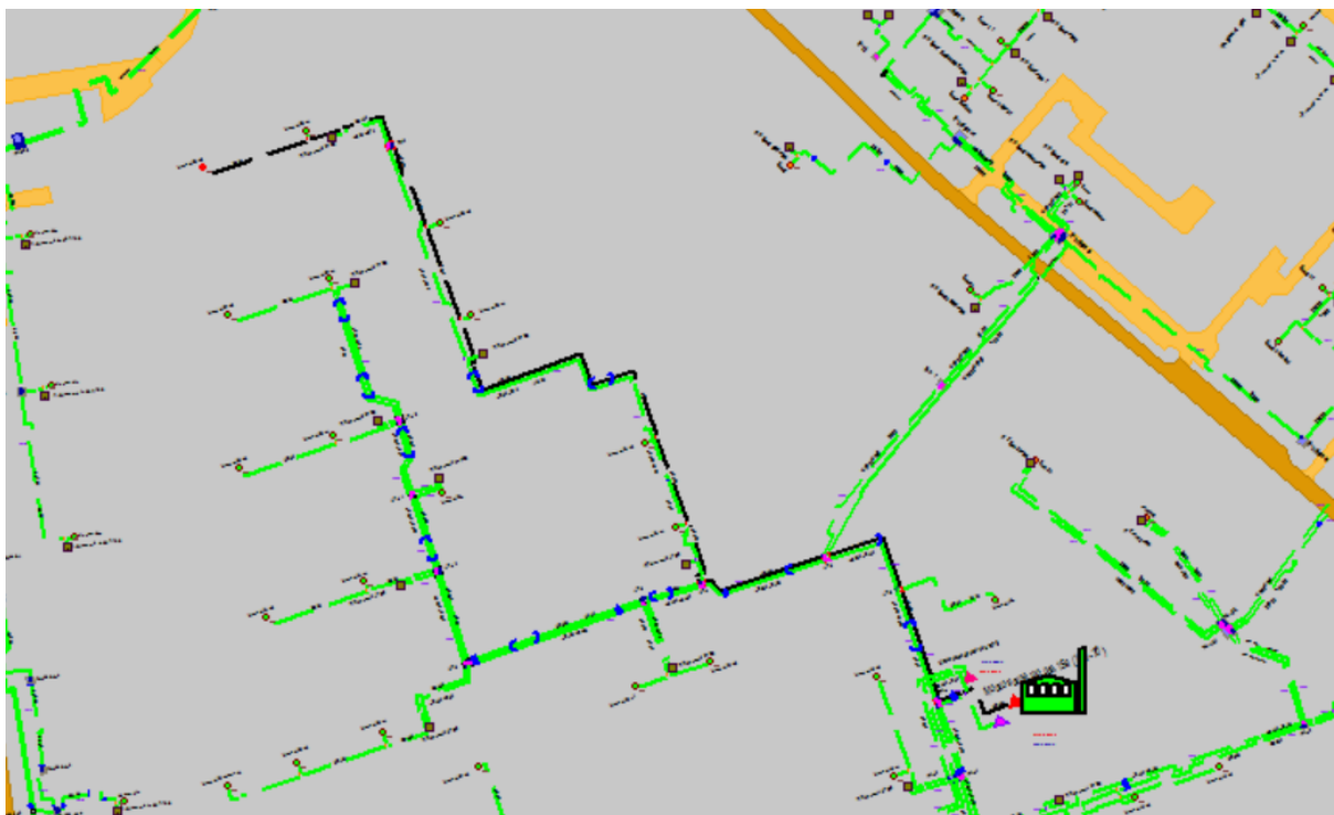
Рисунок 1.29 Результат гидравлического расчета - расчетный путь теплоносителя от котельной Московское шоссе, 15а до ПТ-Моск.ш,25 э2
