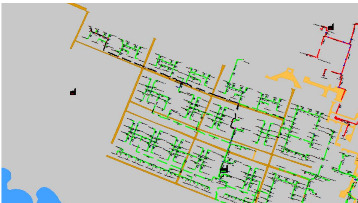
Рисунок 1.195 Результат гидравлического расчета - расчетный путь теплоносителя от котельной Планетная, 8а до ПТ-Ясная,24
