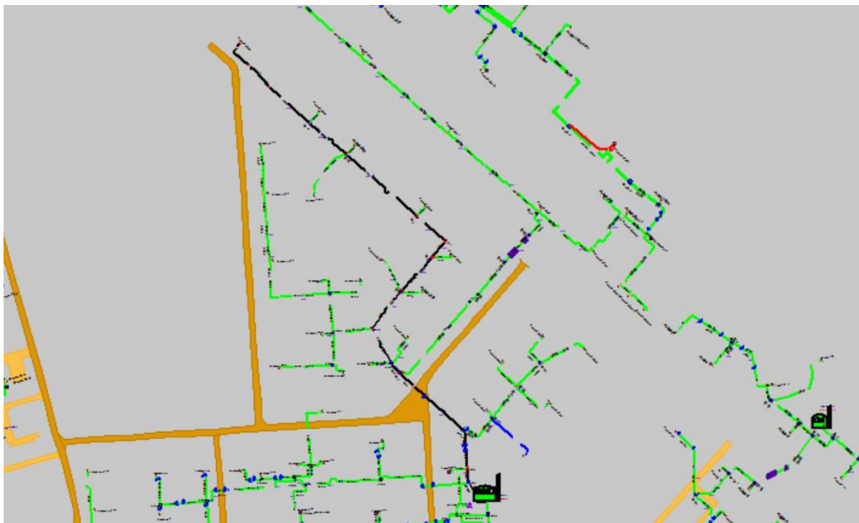
Рисунок 1.143 Результат гидравлического расчета - расчетный путь теплоносителя от котельной Гастелло, 1-а до ПТ-Героев пр,52
