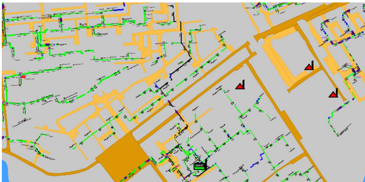
Рисунок 1.123 Результат гидравлического расчета - расчетный путь теплоносителя от котельной Энгельса, 1-в до ПТ-Ефрем,2 э1
