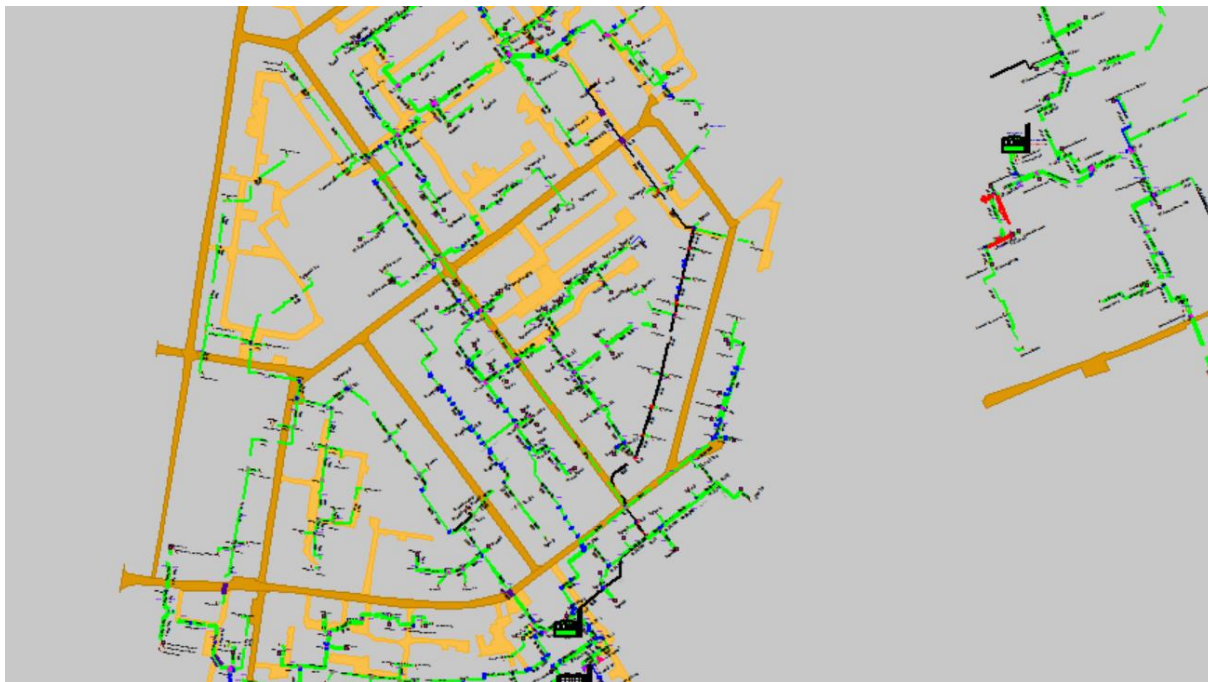
Рисунок 1.151 Результат гидравлического расчета - расчетный путь теплоносителя от котельной Углова, 7 до ПТ-Луган, 7
