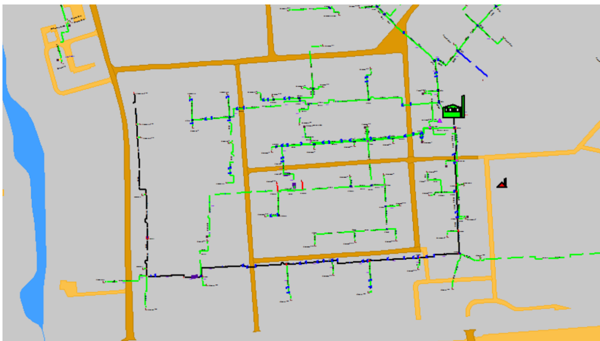
Рисунок 1.141 Результат гидравлического расчета - расчетный путь теплоносителя от котельной Гастелло, 1-а до ПТ-Березов,5 вв3
