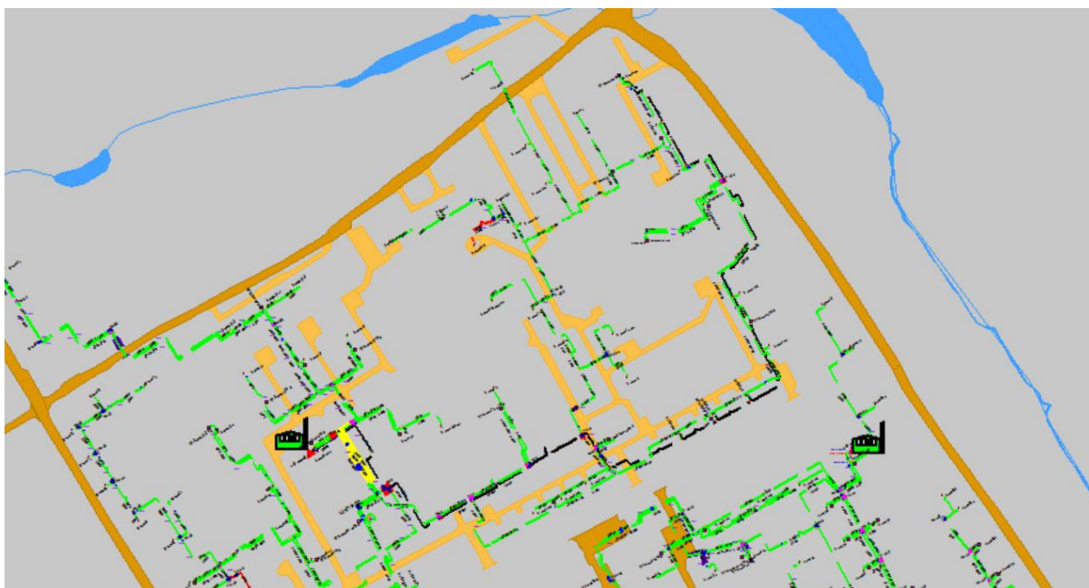
Рисунок 1.191 Результат гидравлического расчета - расчетный путь теплоносителя от котельной Баренца, 9а до ПТ-Барен.3а
