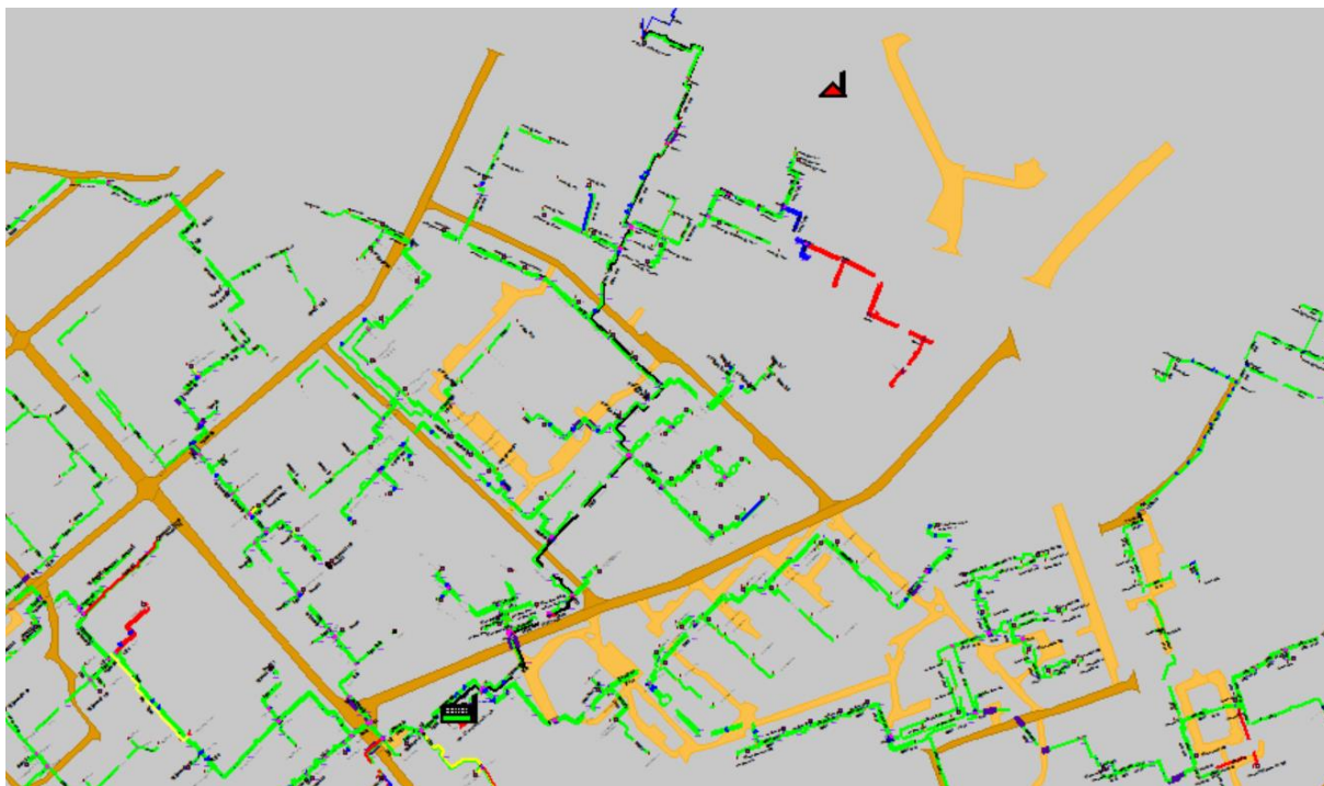
Рисунок 1.63 Результат гидравлического расчета - расчетный путь теплоносителя от котельной пр. Союзный, 43 до ПТ-Радищ,18
