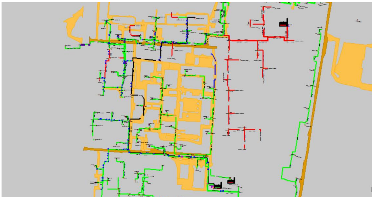
Рисунок 1.179 Результат гидравлического расчета - расчетный путь теплоносителя от котельной Гагарина, 60 корп. 22 до ПТ-Краснозв, 12а вв2
