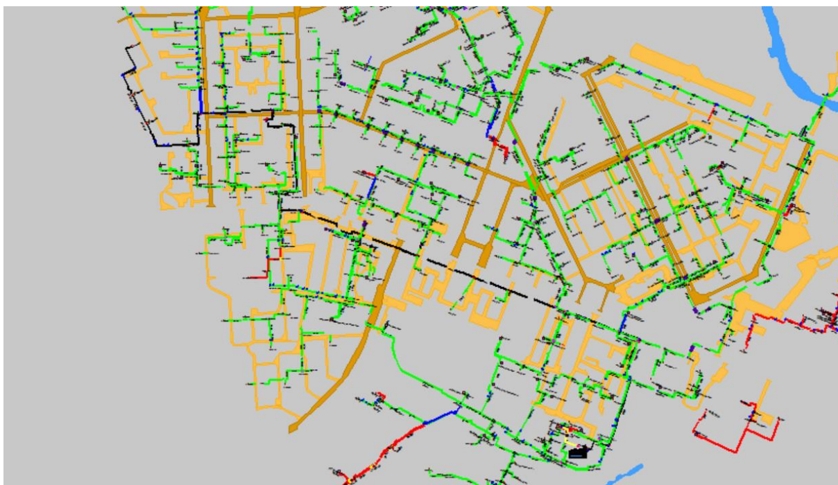
Рисунок 1.93 Результат гидравлического расчета - расчетный путь теплоносителя от котельной Чаадаева, 10 до ПТ-Мечн,63.
