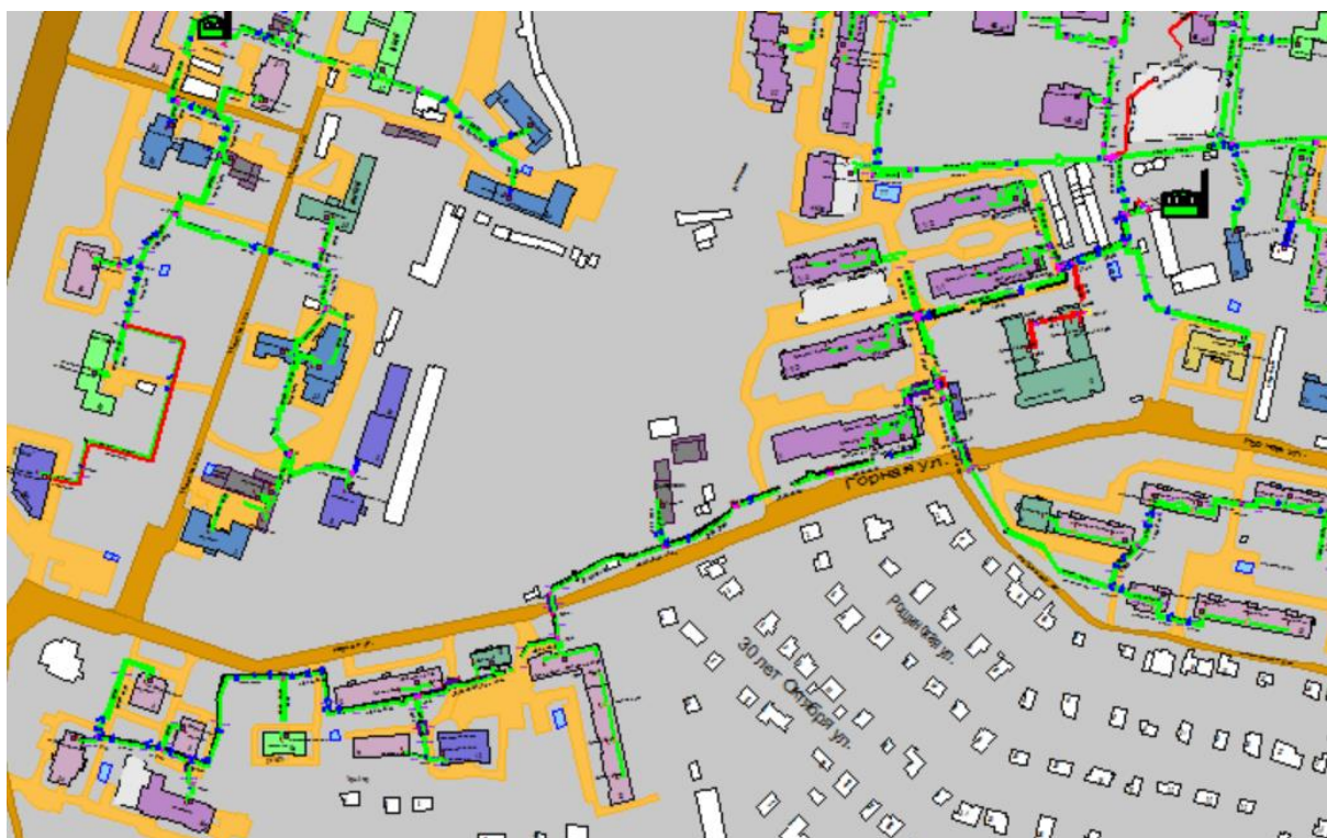
Рисунок 1.161 Результат гидравлического расчета - расчетный путь теплоносителя от котельной Горная, 13 до ПТ-Горная,2а
