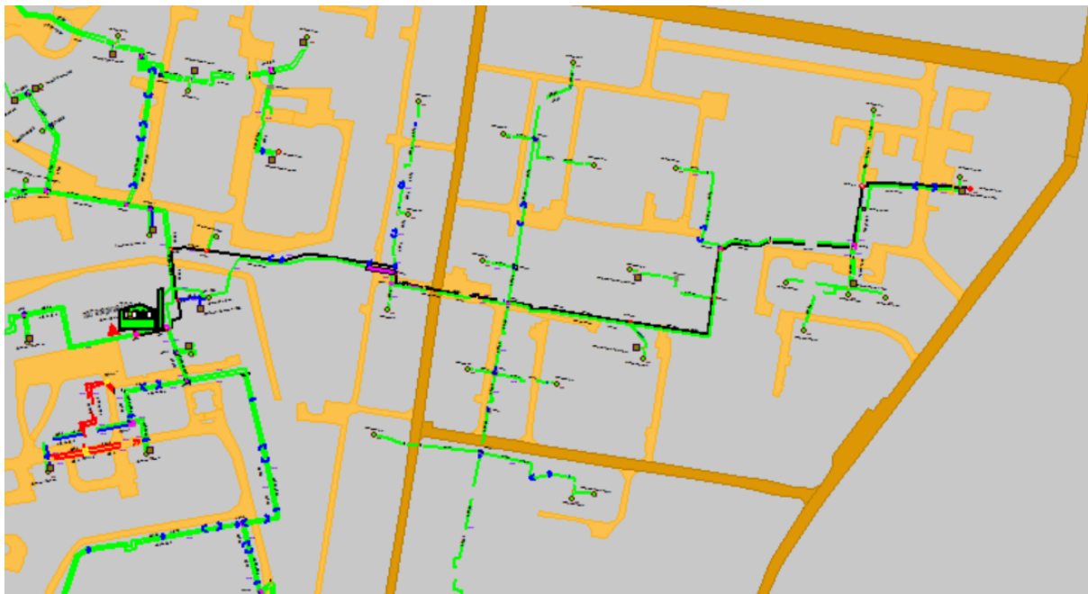
Рисунок 1.47 Результат гидравлического расчета - расчетный путь теплоносителя от котельной пр. Гагарина, 70а до ПТ-Медицин,13 э1
