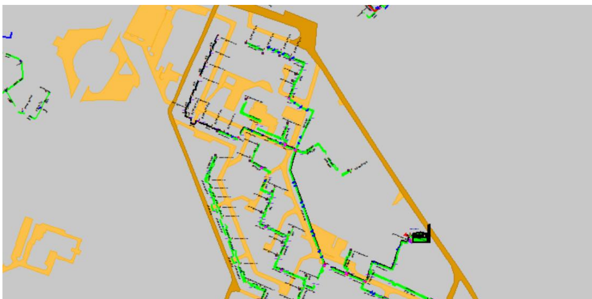
Рисунок 1.165 Результат гидравлического расчета - расчетный путь теплоносителя от котельной 40 лет Победы, 15 до ПТ-Победы 40лет,1 э10
