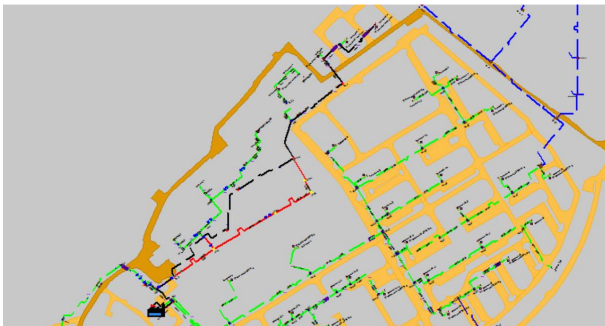
Рисунок 1.169 Результат гидравлического расчета - расчетный путь теплоносителя от котельной Цветочная, 3-а до ПТ-Цветочная,7/2
