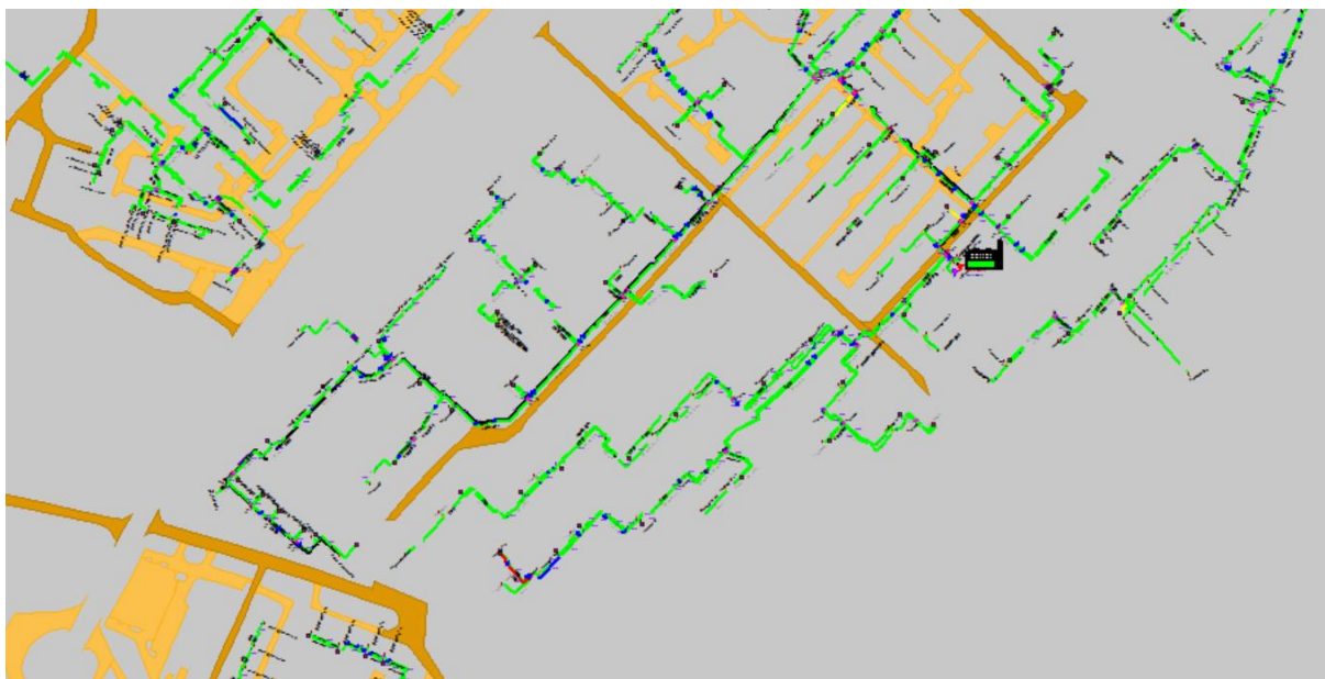
Рисунок 1.153 Результат гидравлического расчета - расчетный путь теплоносителя от котельной Военных комиссаров, 9 до ПТ-Гагар.пр,226 пристр
