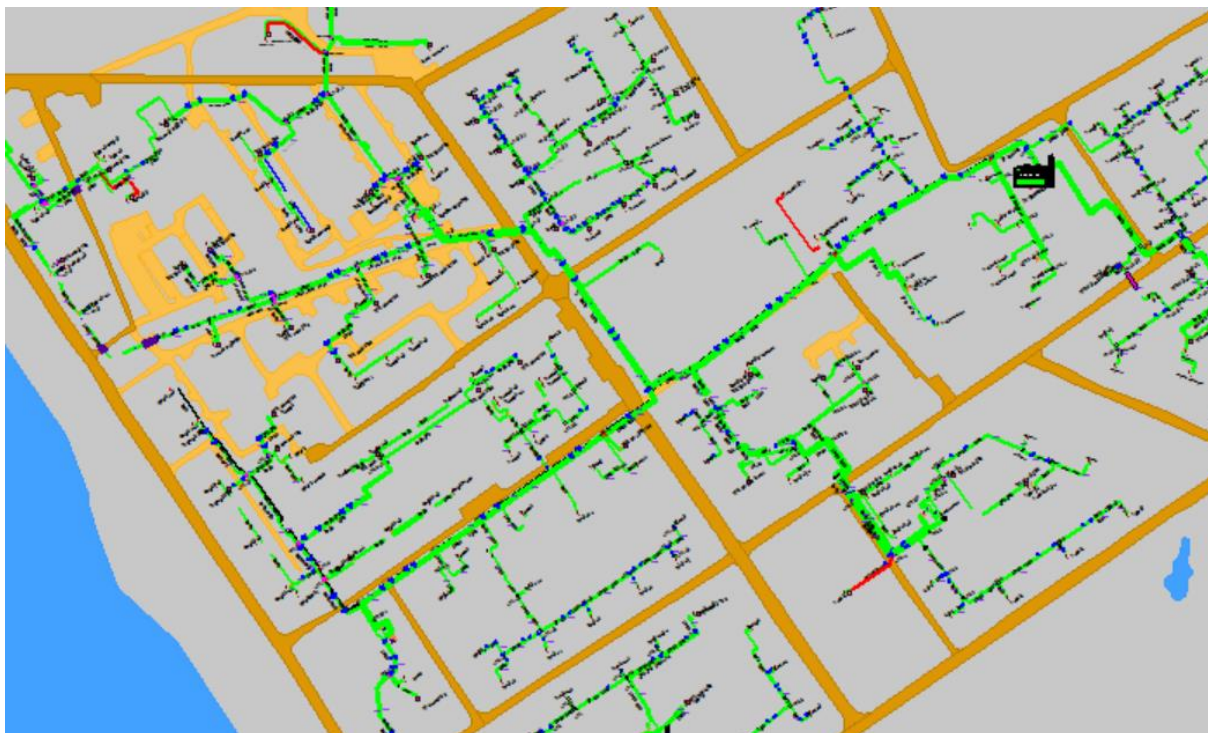
Рисунок 1.101 Результат гидравлического расчета - расчетный путь теплоносителя от котельной Таллинская, 15в до ПТ-Архан,24 вв2
