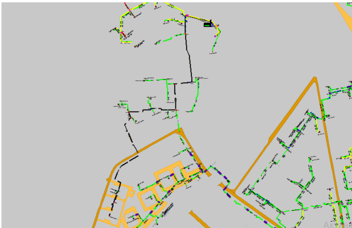
Рисунок 1.31 Результат гидравлического расчета - расчетный путь теплоносителя от котельной пр. Гагарина, 97 до ПТ-Гагар,97 общ.№1
