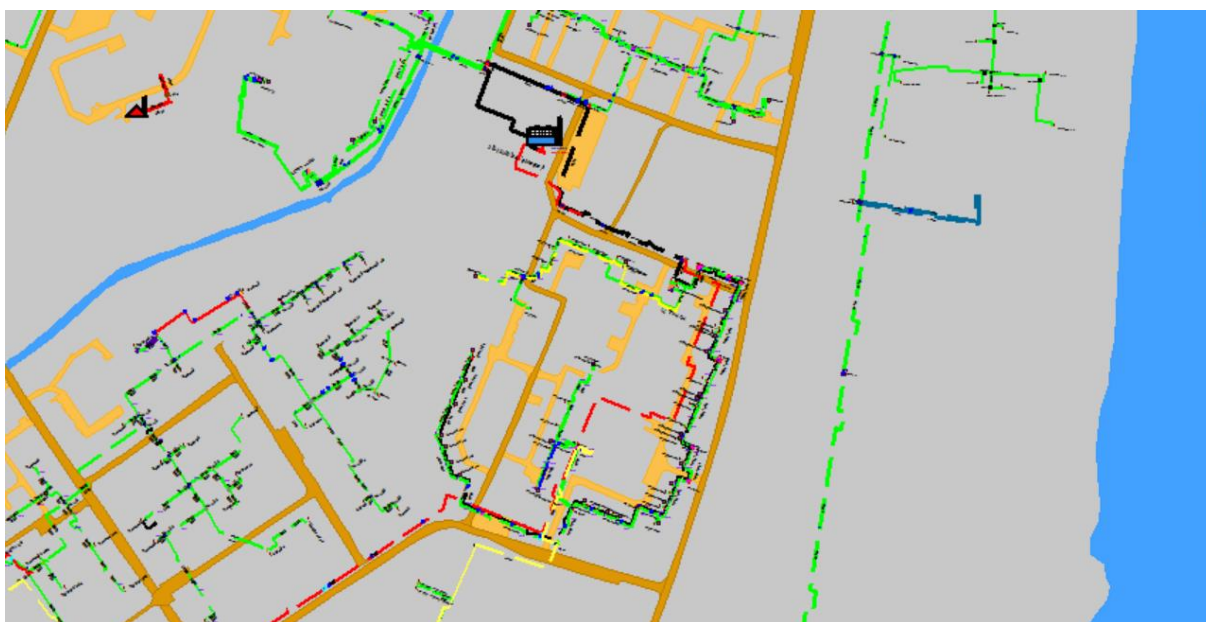
Рисунок 1.185 Результат гидравлического расчета - расчетный путь теплоносителя от котельной Заводская, 19 до ПТ-Кашир,70 эЗ
