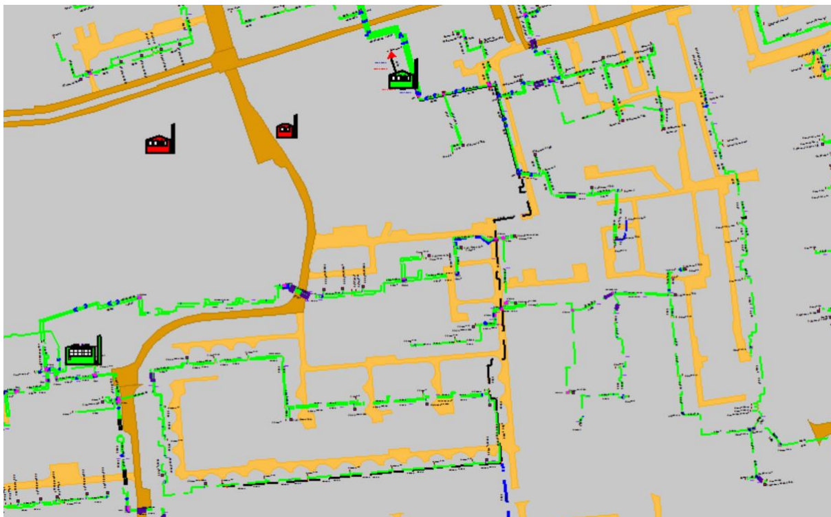
Рисунок 1.81 Результат гидравлического расчета - расчетный путь теплоносителя от котельной ул. Базарная, 6 до ПТ-Культ,3 э7
