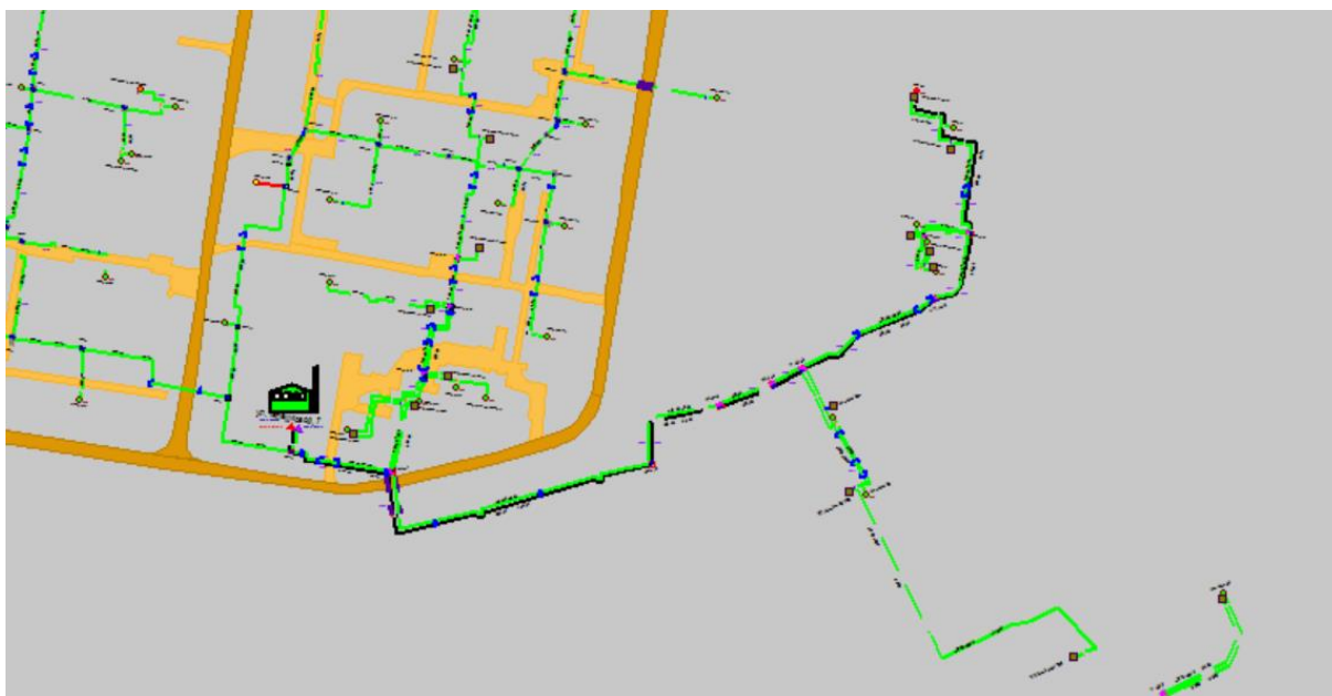
Рисунок 1.217 Результат гидравлического расчета - расчетный путь теплоносителя от котельной Терешковой, 7 до ПТ-Гжат,6
