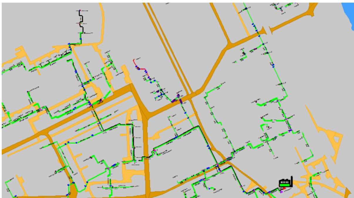
Рисунок 1.33 Результат гидравлического расчета - расчетный путь теплоносителя от котельной Баранова, 11 до ПТ-Мечн, 74 маст
