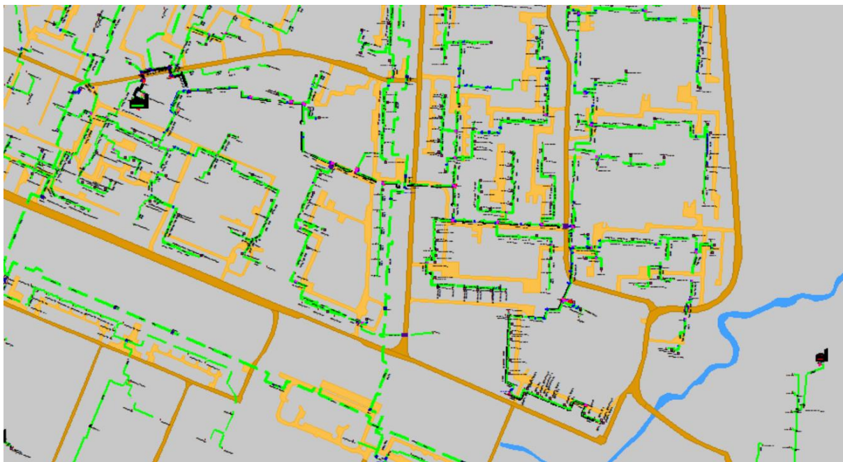
Рисунок 1.131 Результат гидравлического расчета - расчетный путь теплоносителя от котельной Академика Баха, 4-а до ПТ-Макар, 18 э2
