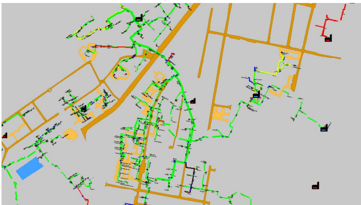
Рисунок 1.97 Результат гидравлического расчета - расчетный путь теплоносителя от котельной Чкалова, 9д до ПТ-Вольск,8
