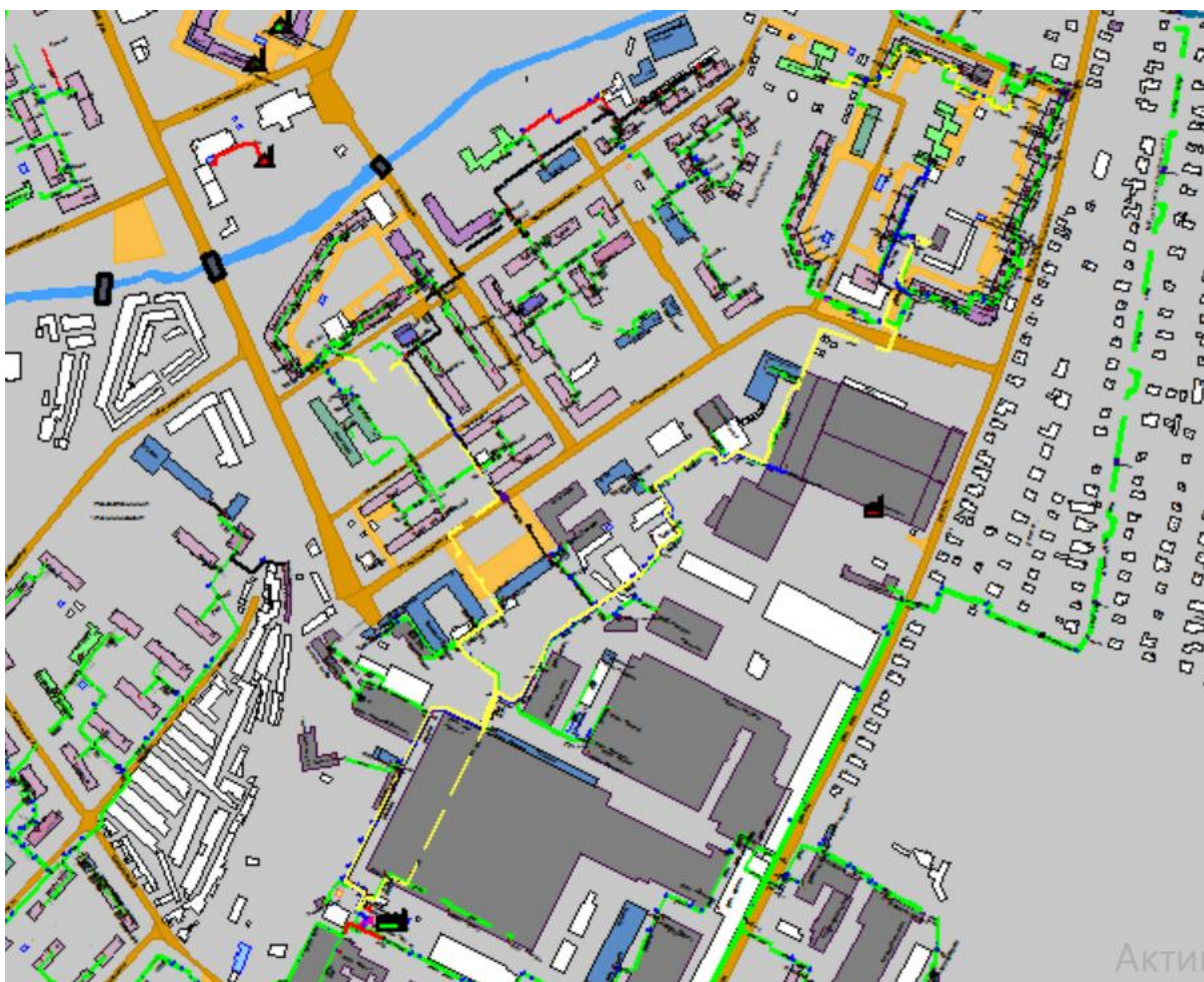
Рисунок 1.13 Результат гидравлического расчета - расчетный путь теплоносителя от котельной Памирская, 11 до ПТ-Памир,2
